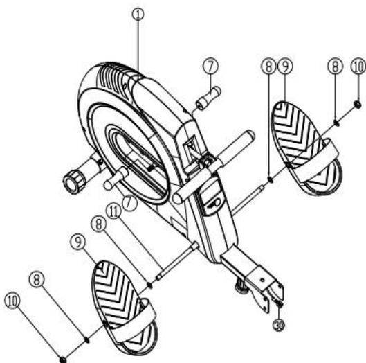
Установите две рукоятки (7) на основную раму (1). Пропустите ось (11) через основную раму. Затем закрепите педали (9) на оси с помощью четырех шайб (8) и двух нейлоновых гаек (10).
