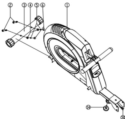
Установите передний стабилизатор (3) на основную раму (1) и закрепите с помощью двух комплектов болтов (2), изогнутых шайб (4), пружинных шайб (5) и гаек (6). Затем установите компенсатор пола (14) на основную раму (1).
