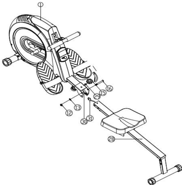
Подсоедините кабель (30) к кабелю датчика (31), а затем закрепите раму сиденья (28) на основной раме (1) с помощью нейлоновой гайки (12), шайбы (13), болта (16), ручки (15) и шайбы (29).
