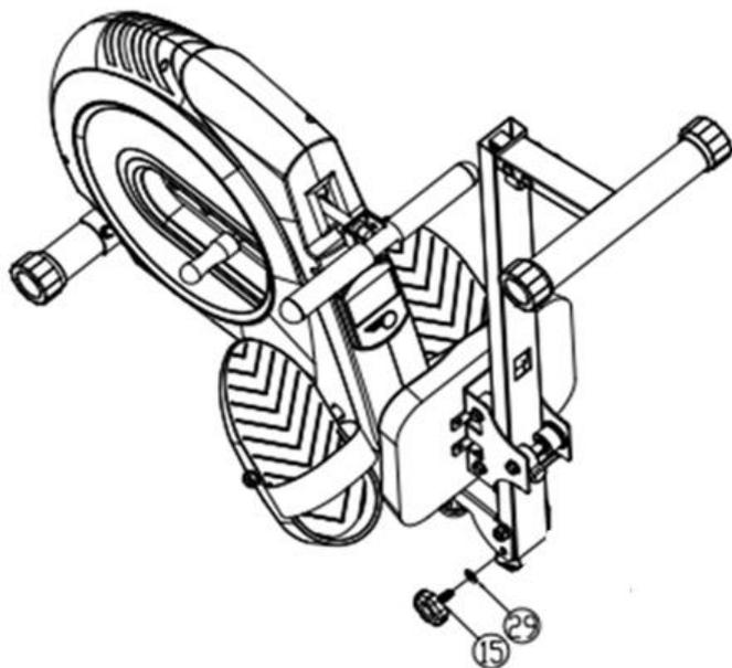
Гребной тренажер имеет функцию складывания. Перед тем как сложить тренажер, опустите ручку (15) и шайбу (29) вниз. Можно зафиксировать сложенный тренажер с помощью ручки (15) и шайбы (29), как показано ниже.
