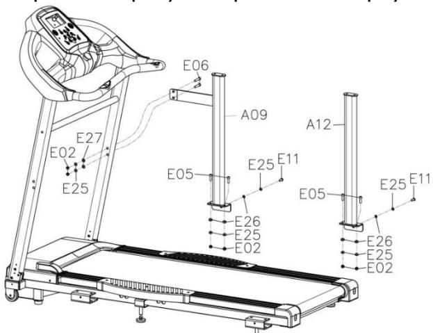
Используйте болт (№E11), стопорную шайбу (№E25) и стопорную шайбу (№E26), чтобы закрепить стойку сбоку, а также 2 болта (№E05), 2 гайки (№E02), 2 стопорные шайбы (№E25) и 2 стопорные шайбы (№E26), чтобы закрепить стойку спереди. Закрепите детали с помощью шестигранного ключа (№B04).
