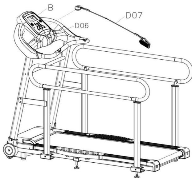
Перед запуском беговой дорожки установите ключ безопасности (№D07) на магнитную область консоли (№B) и прикрепите конец ключа безопасности к одежде.
