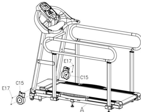
Установите левый и правый кожухи стоек (№C15) на основной раме (№A). Закрепите детали с помощью 2 болтов (№E17) с каждой стороны. Затяните детали с помощью гаечного ключа с отверткой (№B03).
