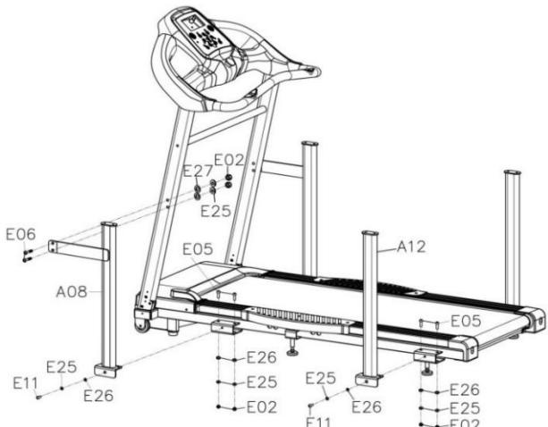
Повторите описанный выше шаг, чтобы установить левую переднюю опорную стойку (№A08), левую вертикальную стойку (№A04) и заднюю опорную стойку (№A12) к основной раме (№ A).
