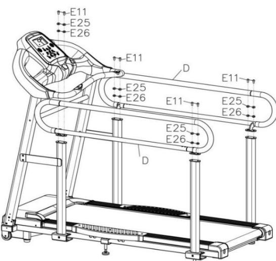
Закрепите левый боковой поручень (№D) на левых опорных стойках. Используйте 4 болта (№E11), 4 стопорные шайбы (№E25) и 4 стопорные шайбы (№E26). Закрепите детали с помощью шестигранного ключа (№B04). Повторите тот же шаг, чтобы завершить сборку правого бокового поручня (№D).
