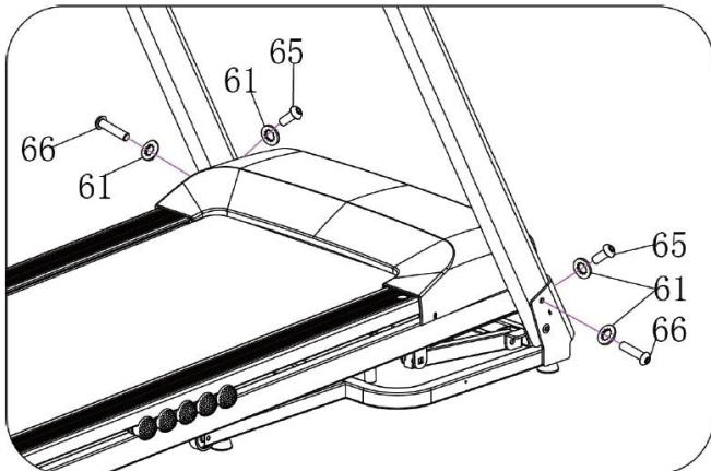
Используйте шестигранный ключ 5#, шестигранный винт с плоской круглой головкой M8\*45 (66), стопорную шайбу (61) и плотно зафиксируйте стойку на основной раме.
