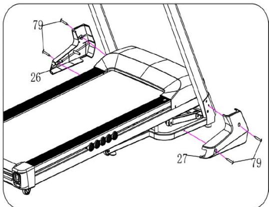
1. С помощью крестообразного гаечного ключа установите саморезы с крестообразной головкой и саморезы (79), затем зафиксируйте левый кожух основания.
