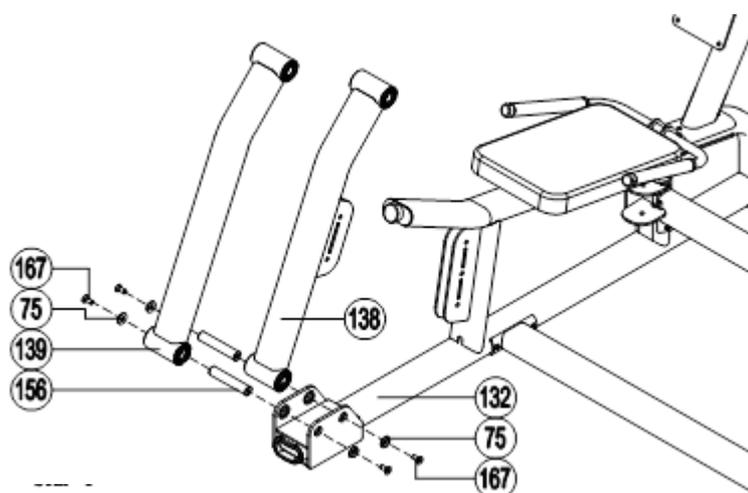
Установите поворотную стойку (138) вместе с рамой сиденья (132), выровняйте отверстия; затем вставьте втулку (156) и закрепите с помощью шестигранного болта (167) и шайбы (75) с двух сторон.
