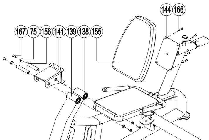
Установите кронштейн (141) на внутренней и внешней поворотных стойках (138) (139), совместите отверстия; затем вставьте втулку (156) и закрепите с помощью шестигранного болта (167) и шайбы (75) с двух сторон.
