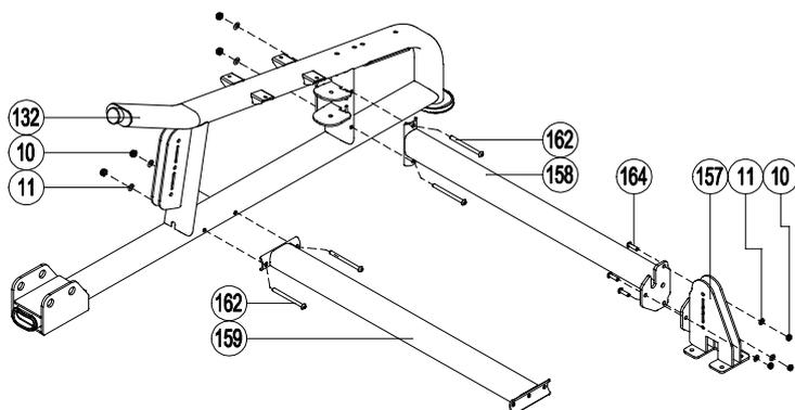
Установите переднее поперечное соединение (159) вместе с рамой сиденья (132), закрепите с помощью шестигранного болта (162), плоской шайбы (11) и шестигранной контргайки (10).
