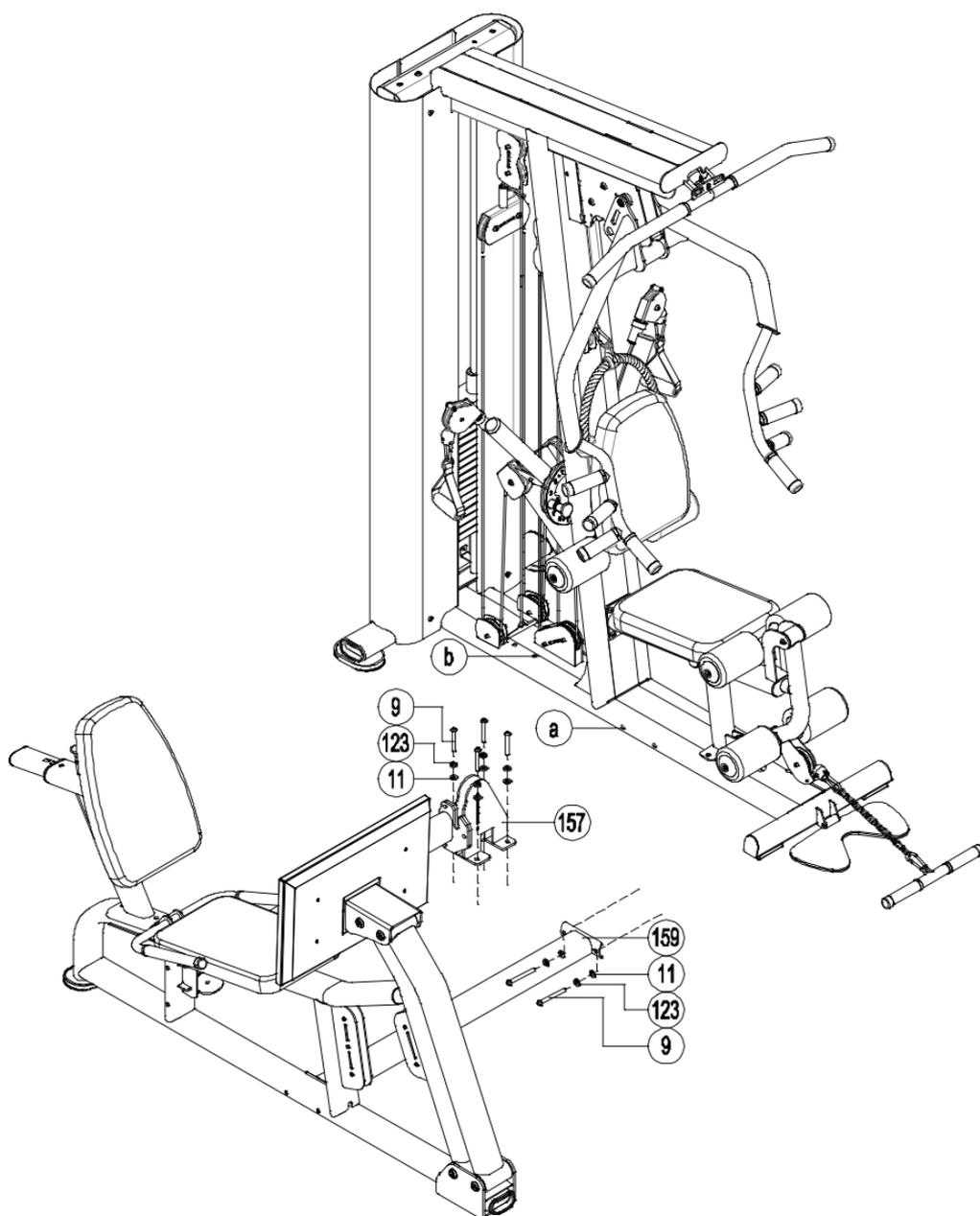
**Шаг 2. Снимите кабель с тренажера Multi Gym в соответствии с приведенной ниже инструкцией (данный шаг включает в себя детали многофункциональной станции Multi Gym).**
