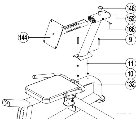
Установите опору кронштейна спинки сиденья (152) на раму сиденья (132) и закрепите с помощью шестигранного болта (9), плоской шайбы (11) и шестигранной контргайки (10).
