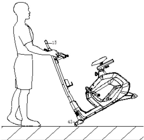
Чтобы переместить тренажер, надавите на руль (15) так, чтобы транспортировочные колеса (42 и 43) на переднем стабилизаторе коснулись земли. Теперь в данном положении можно легко перемещать тренажер в нужное место.
