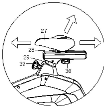
Поверните регулировочную ручку (39) против часовой стрелки, чтобы отрегулировать высоту сиденья (29). Поверните регулировочную ручку (36) против часовой стрелки, чтобы отрегулировать расстояние по горизонтали в соответствии со стрелками на раме сиденья (28).
