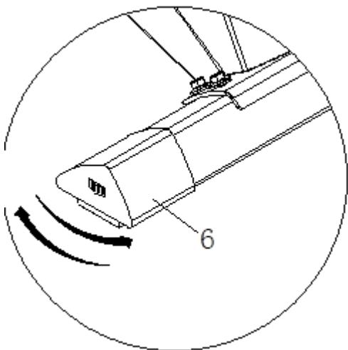
Если данное изделие расположено на неровной поверхности, отрегулируйте компенсаторы пола с обеих сторон тренажера (6 и 7) в соответствии с рисунком.
