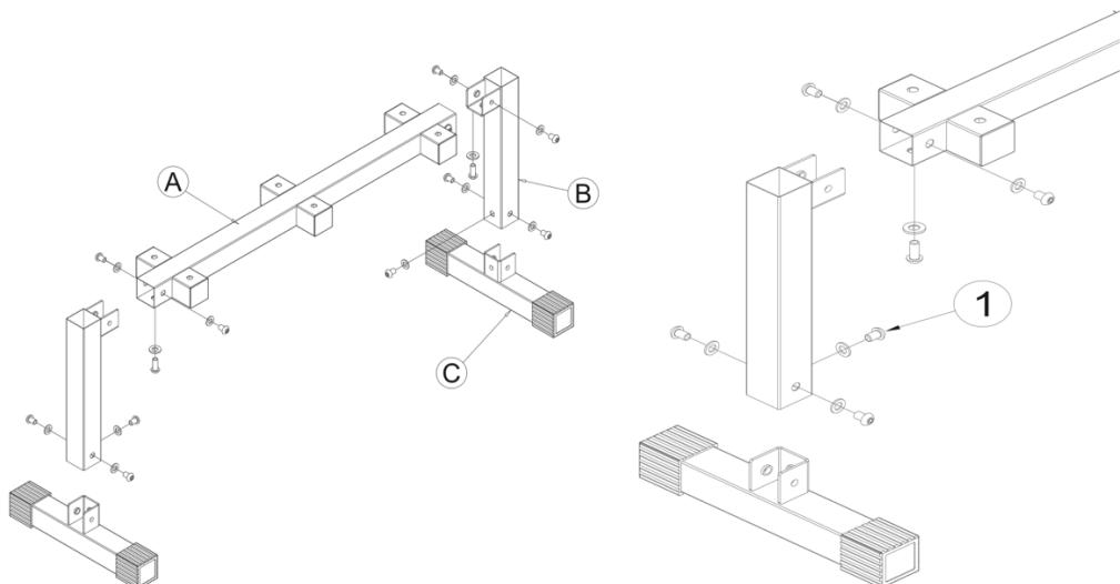
Соедините части А, В и С и закрепите с помощью 12 болтов M10x16 мм и 12 шайб M10.
