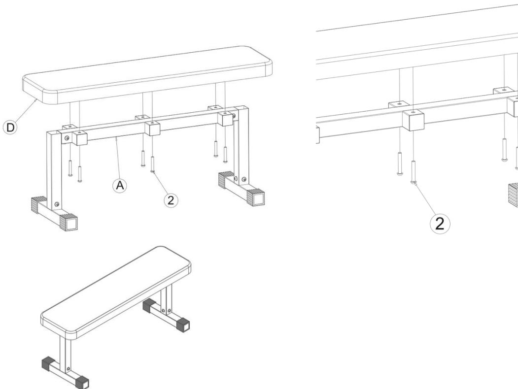
Установите часть D на часть А и закрепите с помощью шести болтов M8 x 60 мм.
