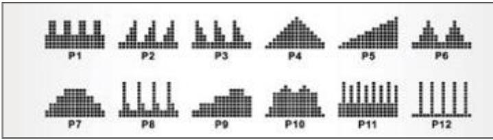
**FITNESS (ПРОГРАММА ФИТНЕС)** - войдите в данный режим и подтвердите, затем установите время на 12 мин, сопротивление на 6 и нажмите START (СТАРТ), чтобы начать программу. Когда время дойдет до 0, на консоли отобразится соответствующий уровень F1-F5 в зависимости от тренировки.
