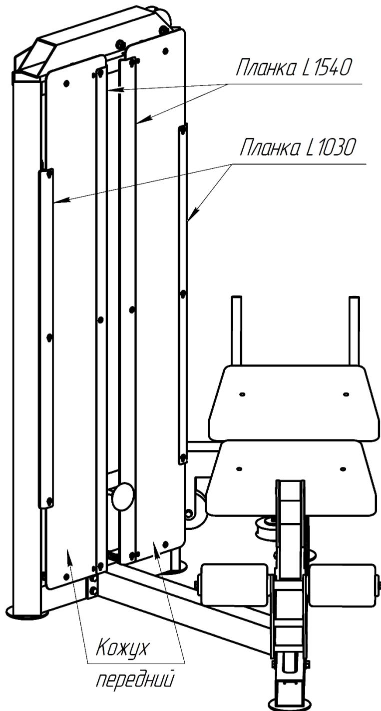
Крепление винтами M6x15. Средние отверстия планки L 1540 крепятся винтами M6x15 и гайкой M6.
