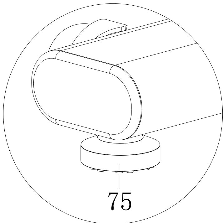
Если данный тренажер расположен на неровной поверхности, отрегулируйте компенсаторы пола с обеих сторон тренажера (75) в соответствии с рисунком.
