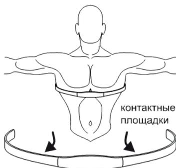
Для более качественного измерения рекомендуем вам перед началом тренировки немного увлажнить контактные площадки водой или специальным электропроводящим гелем. **Не используйте** для этого вазелин и маслосодержащие крема или жидкости, так как они могут иметь изолирующие свойства, препятствующие снятию импульсов с кожи.
