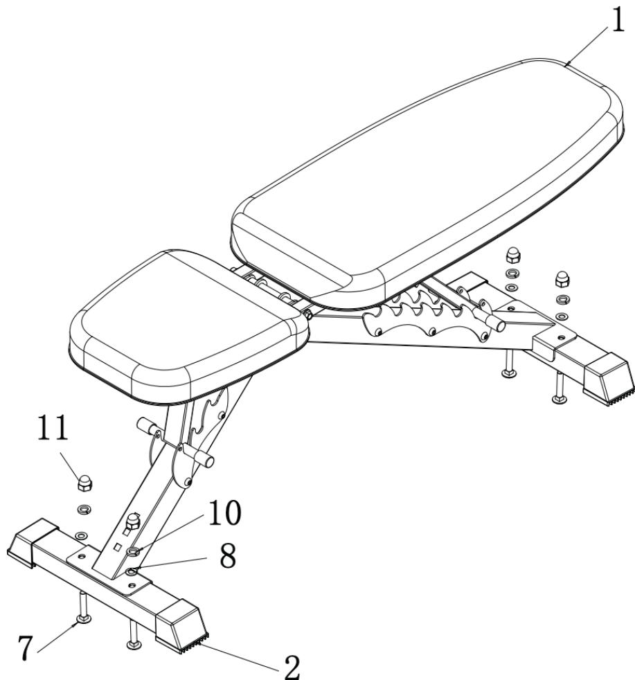
1. Вставьте винт (7) в нижний стабилизатор (2), затем установите вместе с основной рамой (1) и закрепите детали с помощью шайбы (8), шайбы (10), накидной гайки (11) и ключа (13).
