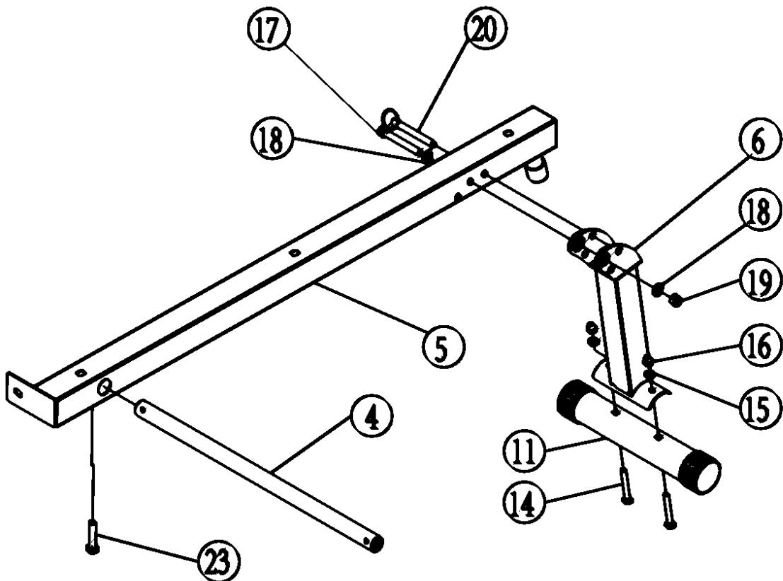
1. Вставьте горизонтальное соединение (4) в опору сиденья (5), затем используйте ключ с открытым концом (34) и винт M10X45 (23), чтобы закрепить детали. Винт должен быть выровнен с центральным отверстием и затянут по часовой стрелке.
