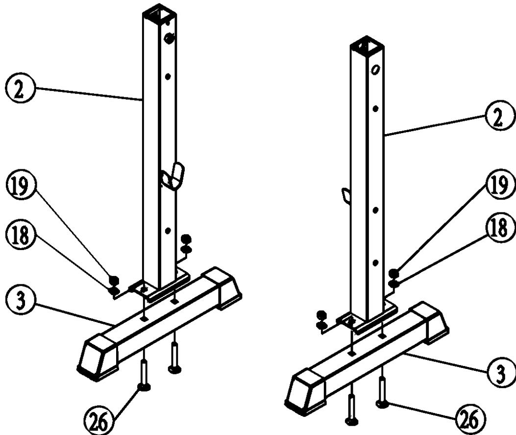
Вставьте болт M10X65 (26) в стабилизатор (3), а затем, чтобы закрепить стойку (2) на стабилизаторе используйте плоскую шайбу Ø 10 (18) и контргайки M10 (19). С помощью гаечного ключа с открытым концом (34) затяните контргайку по часовой стрелке.
