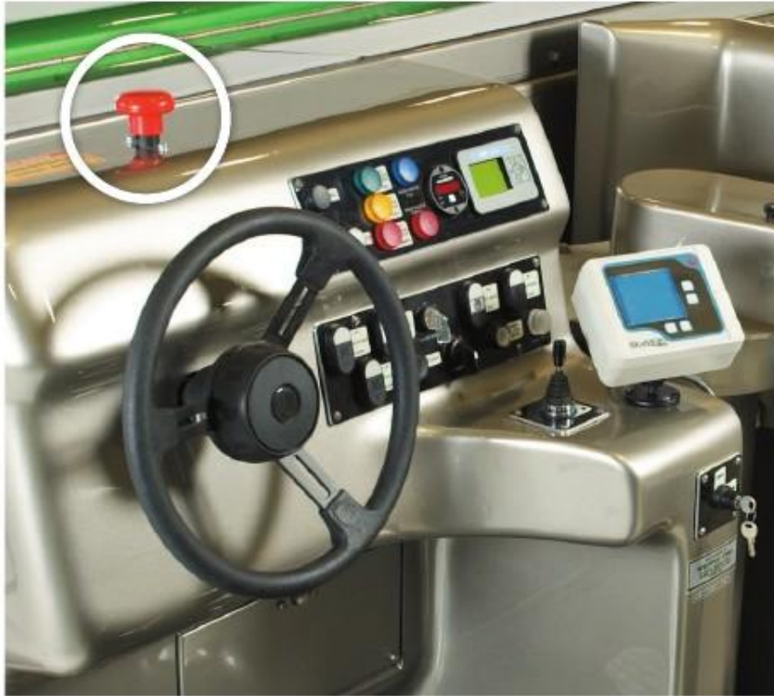
Рис. 5.1. Аварийный выключатель («EMERGENCY Shut Off»).
