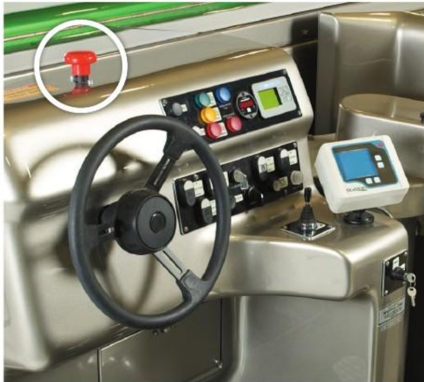
Рис. 1.1. Аварийный выключатель на машине OLYMPIA-E.
