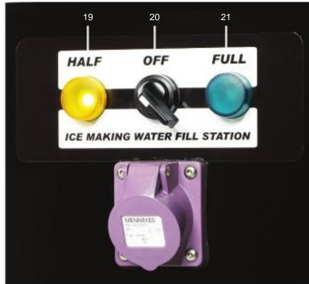
Рис. 5.4. Панель управления заполнением бака с водой для заливки льда.
