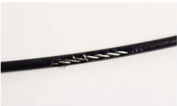
Разрыв покрытия троса
