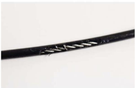
Разрыв покрытия троса
