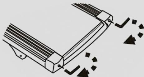
**Поворот против часовой стрелки уменьшит** натяжение бегового полотна
