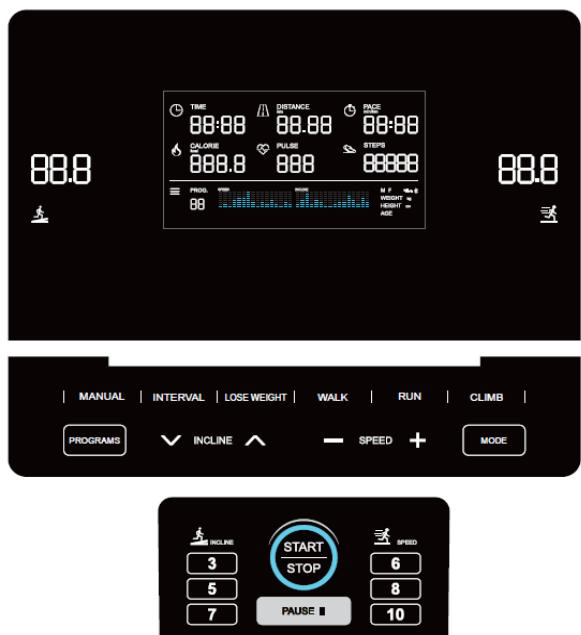
1. Окно «Time» (время): Отображает время выполнения тренировки. Диапазон отображения составляет 0:00 до 18ч. Когда время достигает максимума, система не останавливается и снова начинает отсчет от 0:00; В режиме обратного отсчета диапазон отображения составляет 99-0 мин, при достижении 0:00 в окне появится надпись "END", через 5 секунд беговая дорожка остановится и перейдет в режим ожидания.
