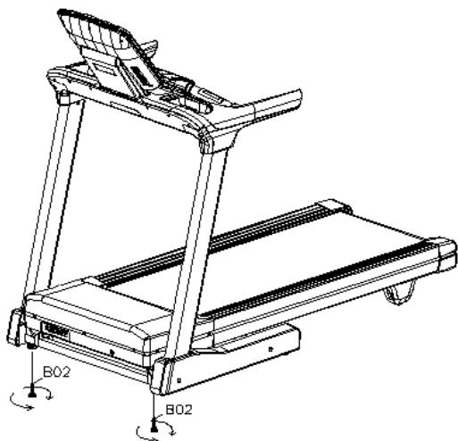
Чтобы выровнять беговую дорожку, отрегулируйте компенсаторы пола (B02), если пол неровный; Если повернуть компенсаторы пола (B02) в левую сторону с помощью гаечного ключа (B08), то беговая дорожка поднимется выше, а если в правую, то опустится ниже.
