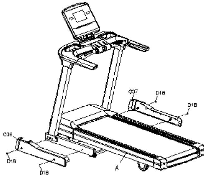
1. Установите нижние кожухи C06 и C07 на основной раме A и закрепите с помощью 4 болтов M5\*16 D18 и торцевого ключа B08.
