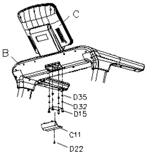
1. Закрепите консоль С на опорной раме В с помощью 4 болтов M8x15 D15, 4 пружинных шайб D32, 4 плоских шайб D35 и внутреннего шестигранного ключа B09.
