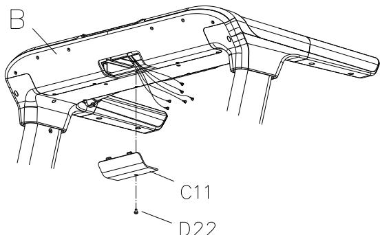
1. Снимите кожух консоли С11 с помощью торцевого ключа В08.
