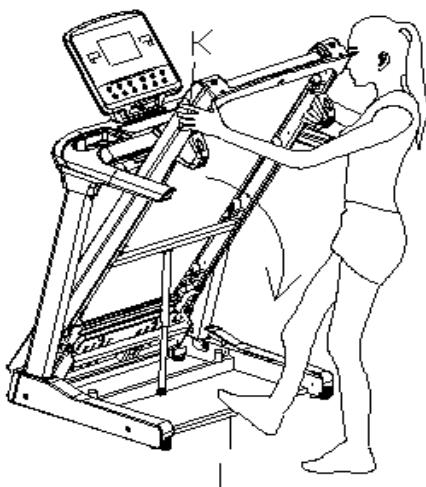
Для того чтобы наклонить тренажер, возьмитесь одной рукой за нижнюю часть рамы "К", чтобы поддерживать верхний конец беговой дорожки. Затем поставьте ногу на планку "L", чтобы удерживать нижний конец беговой дорожки. Теперь медленно наклоняйте верхнюю часть беговой дорожки вниз к полу. Как только рама "К" достигнет достаточно низкой точки, транспортировочные колеса беговой дорожки начнут двигаться.
