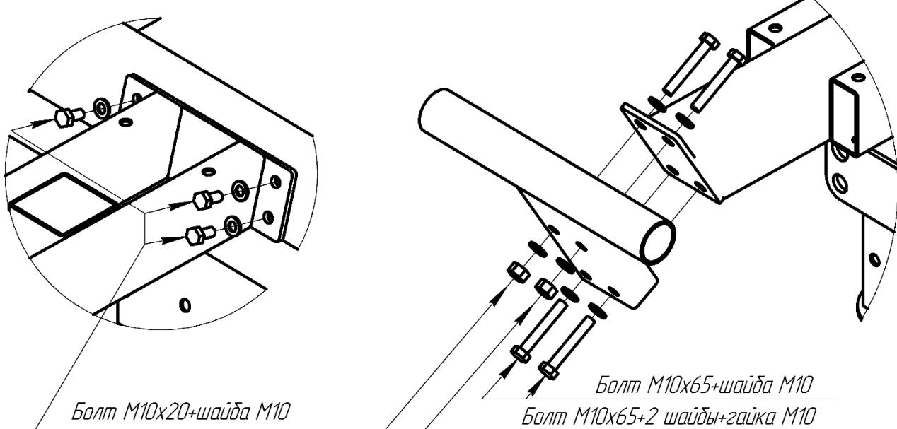
*4. Установка ложемента и планки стопора ложемента.*
